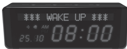
Figura 1.4 | despertador que representa o sistema de controle de circuito aberto
